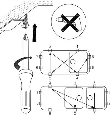
LIGHTLY TIGHTEN ALL CLIPS, LASTLY, TIGHTEN ALL CLIPS IN THE ORDER SHOWN
